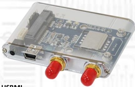
USBMI (無線通信 Mini Card 用 USB アダプタ ver1.3b) x1 IPX→RP-SMA メス変換 RF ケーブル:2 本内蔵済
